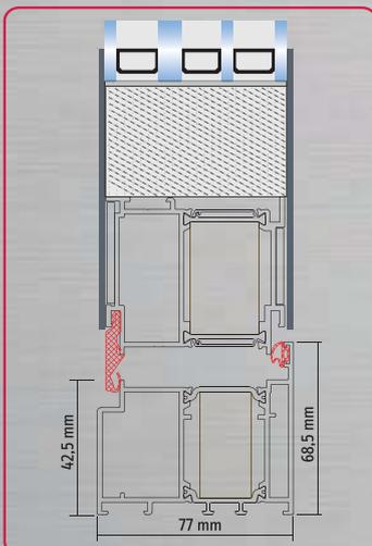
Der integrierte Wetterschenkel und die thermisch getrennte, wasserabweisende Bodenschwelle aus Aluminium sorgen für eine erhöhte Wasserdichtigkeit
